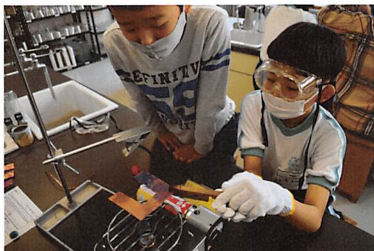
コの字型の金属板を熱している様子
