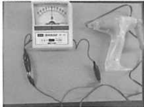
簡易検流計のスイッチを必ず「電磁石」へ
