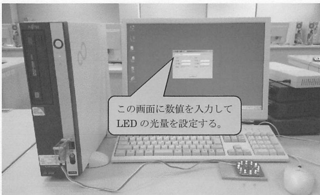
図 4 LED パルサーをコンピュータに接続した様子
